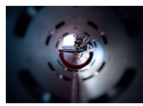
1 Bei der Hydrobar-Technologie wird in die Führungselemente ständig unter Druck Öl eingespeist. Der so entstehende Ölfilm trägt dazu bei, dass das Stangenmaterial stets genau in der Mitte der Führungskanäle zentriert wird © LNS
